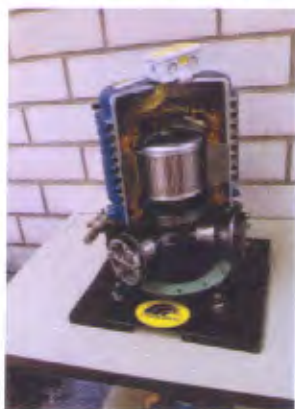
Херметички клипни компресор
